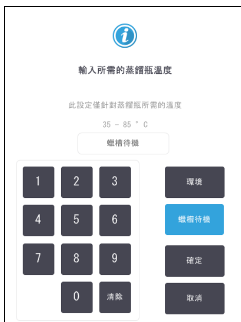
圖 6-2: 將蒸餾瓶溫度設為蠟槽待機溫度
