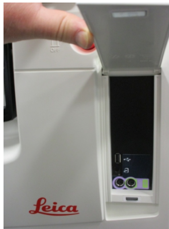
圖 2-19:前 USB 連接埠, 封蓋後面
