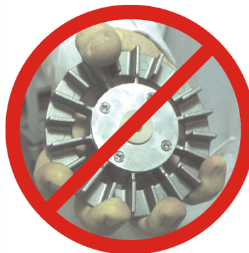
圖 7-9:攪拌器手持方式 - 正確(左), 錯誤(右)
