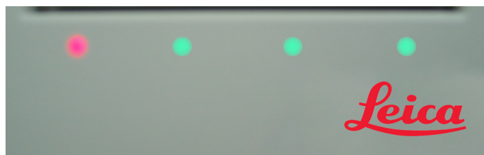
Slika 2-13: Boja LED svetla tacne sa reagensima (crvena, zelena) na BOND-MAX instrumentu
