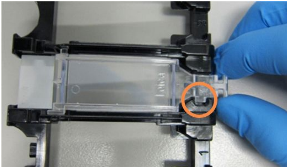
Slika 4-6: Postavljanje Covertile poklopca na slajd
