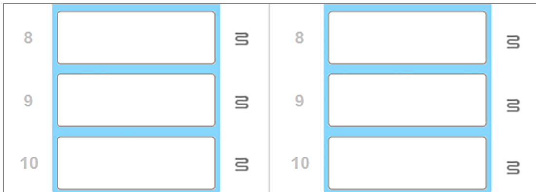
Slika 5-4: Sive oznake grejača na svakoj poziciji ukazuju na potpuno isključivanje grejanja
