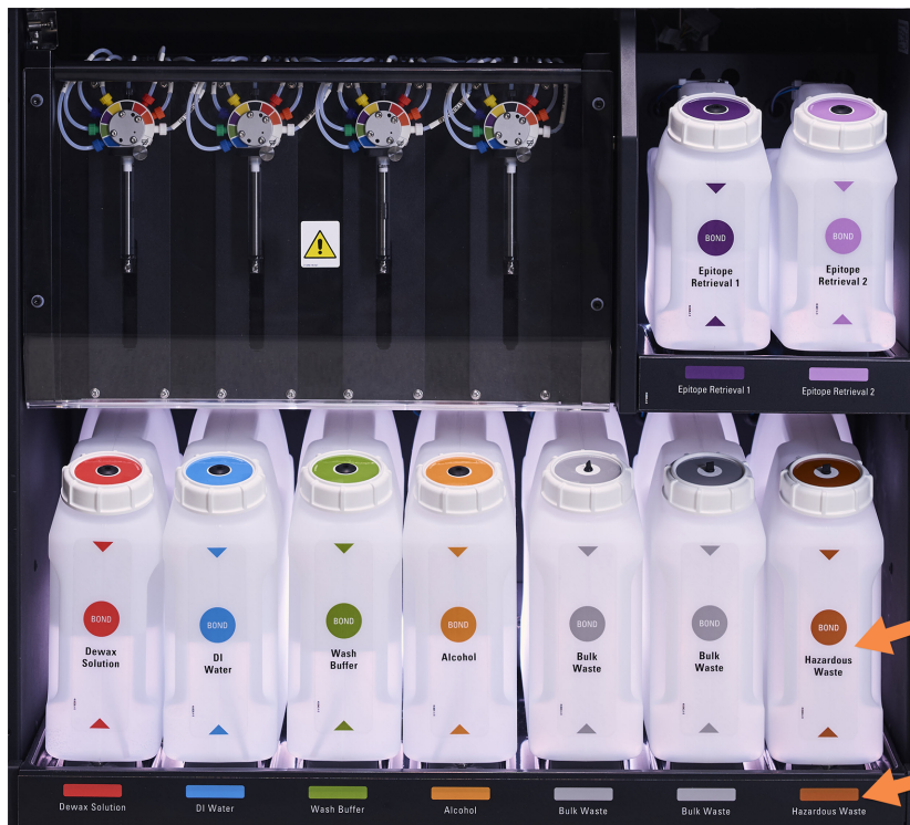
pav. 2–14: BOND-III bazinių reagentų indai vietoje
