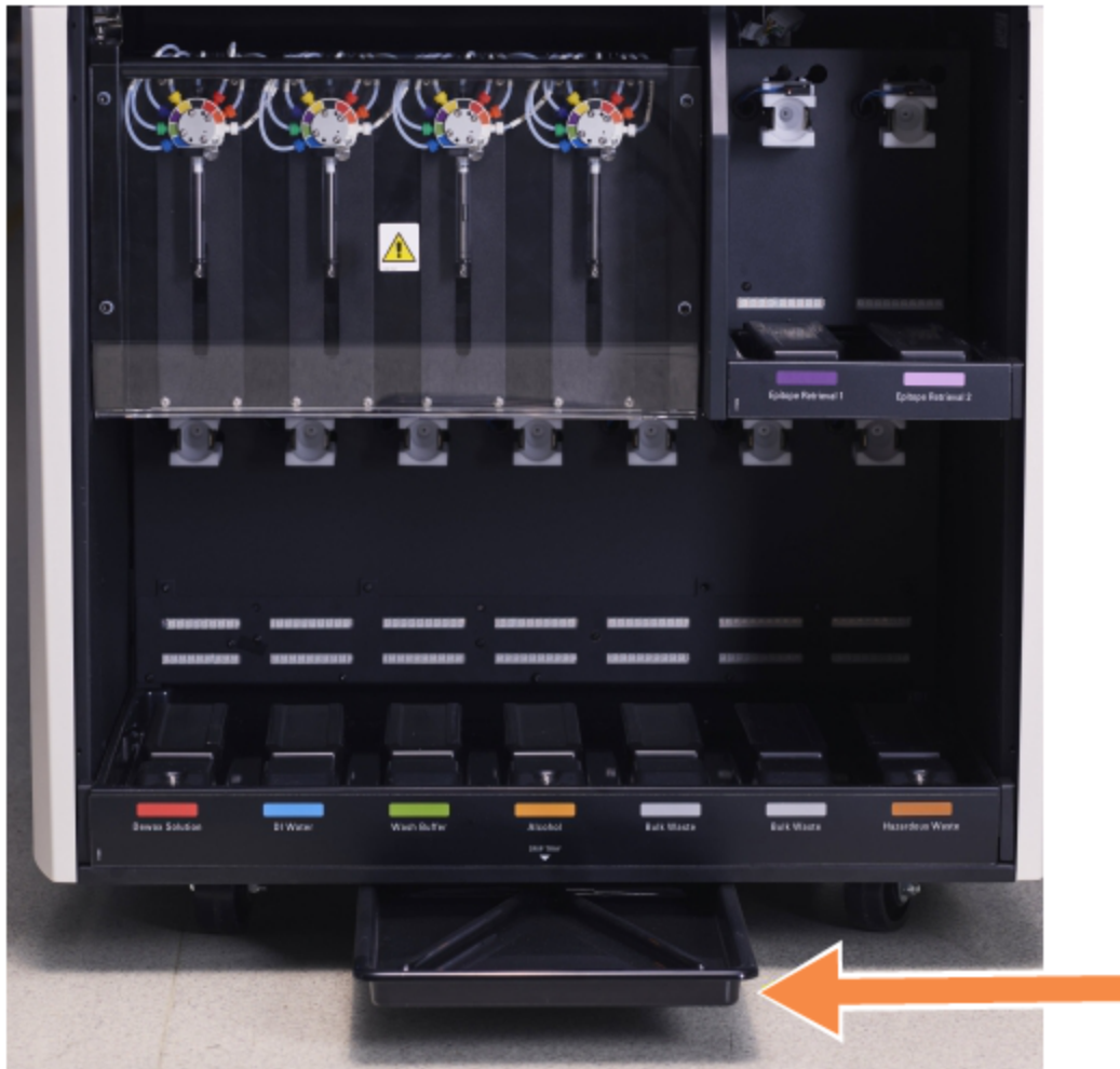
pav. 12–14: BOND-III apdorojimo modulio medžiagų surinkimo padėklas
