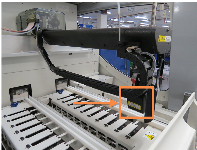
pav. 2–6: Pagrindinio roboto nuotrauka, kurioje ID skaitytuvas pažymėtas rodykle
