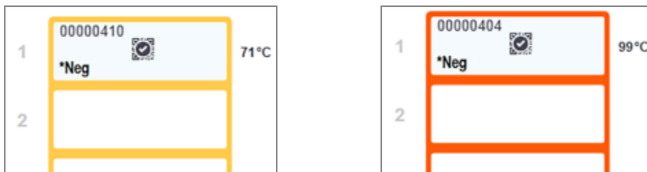
pav. 5–6: Objektinių stiklelių padėklų temperatūros indikacijos kraštai: šilta (kairėje) ir karšta (dešinėje)
