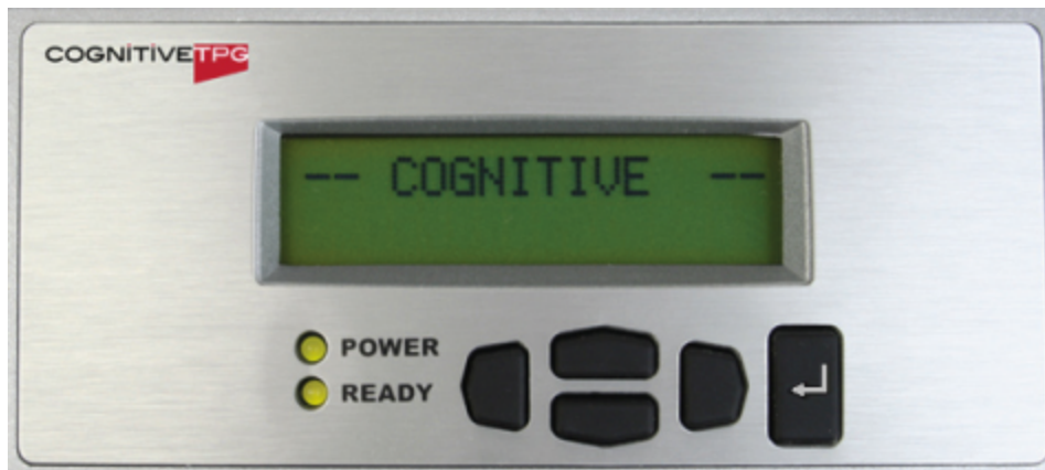
pav. 17-1: „Cognitive“ spausdintuvo LCD ekranas ir klaviatūra
