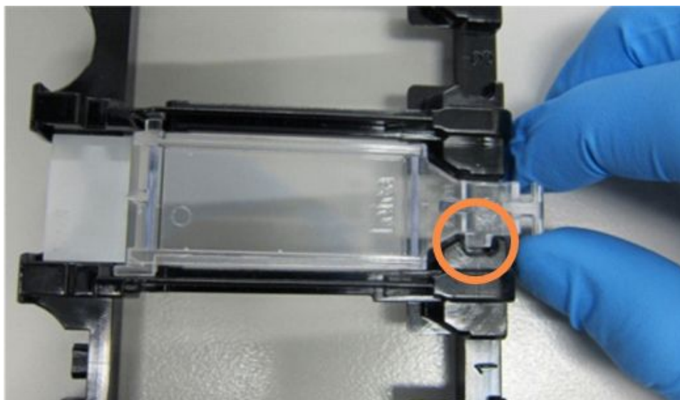
pav. 4–6: „Covertile“ uždėjimas ant objektinio stiklio
